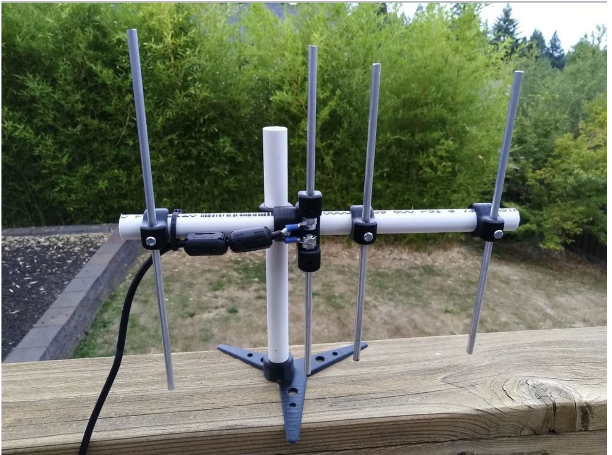
Antenne YAGI « maison » réalisée avec l'impression 3D, tube électrique « IRO » vraisemblablement bande UHF (PMR 446)
