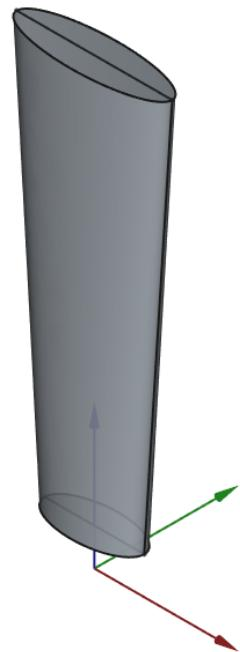
*Nervure obtenue par lissage*
