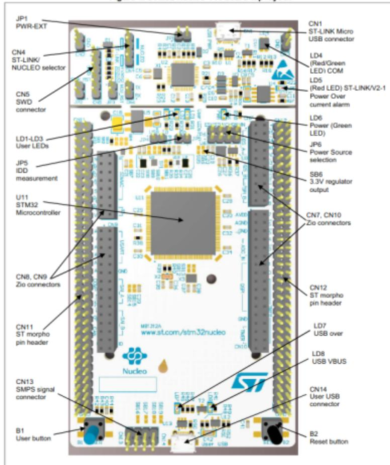
1. -. Vérifiez la position du cavalier sur la carte : JP1 (PWR-EXT) OFF (voir Section 5.5.1 : Entrée d'alimentation de ST-LINK/V2-1 USB connecteur pour plus de détails) JP6 (source d'alimentation) côté STLK (pour plus de détails, voir le tableau 7 : cavalier lié à l'alimentation) JP5 (IDD) ON (pour plus de détails, voir Section 5.8 : JP5 (IDD))CN4 ON sélectionné (pour plus de détails, voir Tableau 4 : états CN4 des cavaliers).
