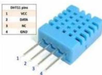
un **DHT11** fournira en **I2C** la température et l'humidité. il sera placé en partie **basse** de la ruche.
