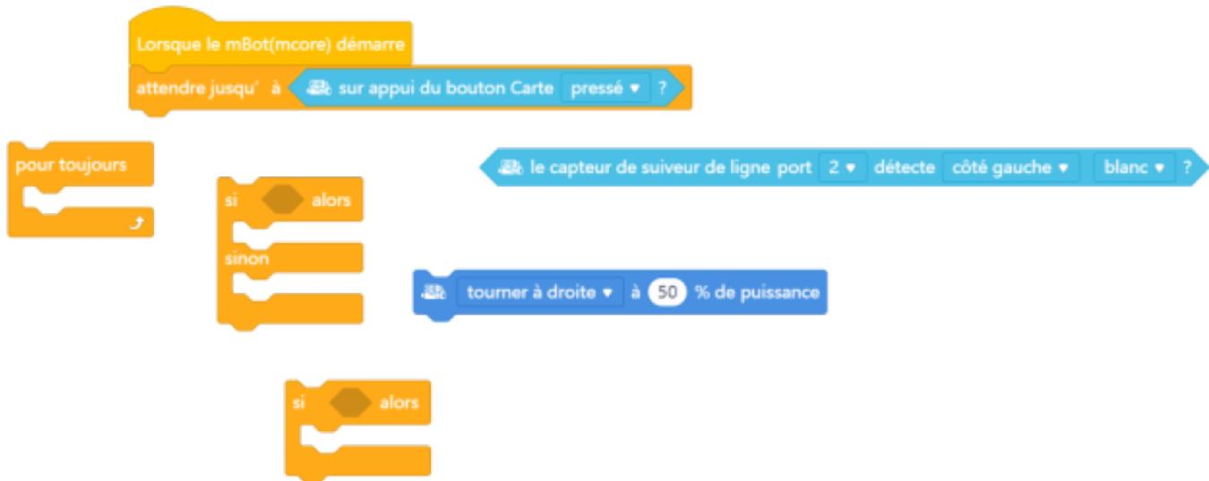
**Détecteur de ligne noire** Le robot dispose de deux phototransistors qui émettent chacun une lumière. Si le robot passe sur une surface claire (idéalement blanche) la lumière réfléchie et le phototransistor associé envoie un signal électrique. Si le robot passe sur une surface noire, la lumière n'est pas réfléchie et aucun signal n'est envoyé. Chaque phototransistor peut donc piloter l'un des moteurs du robot.
