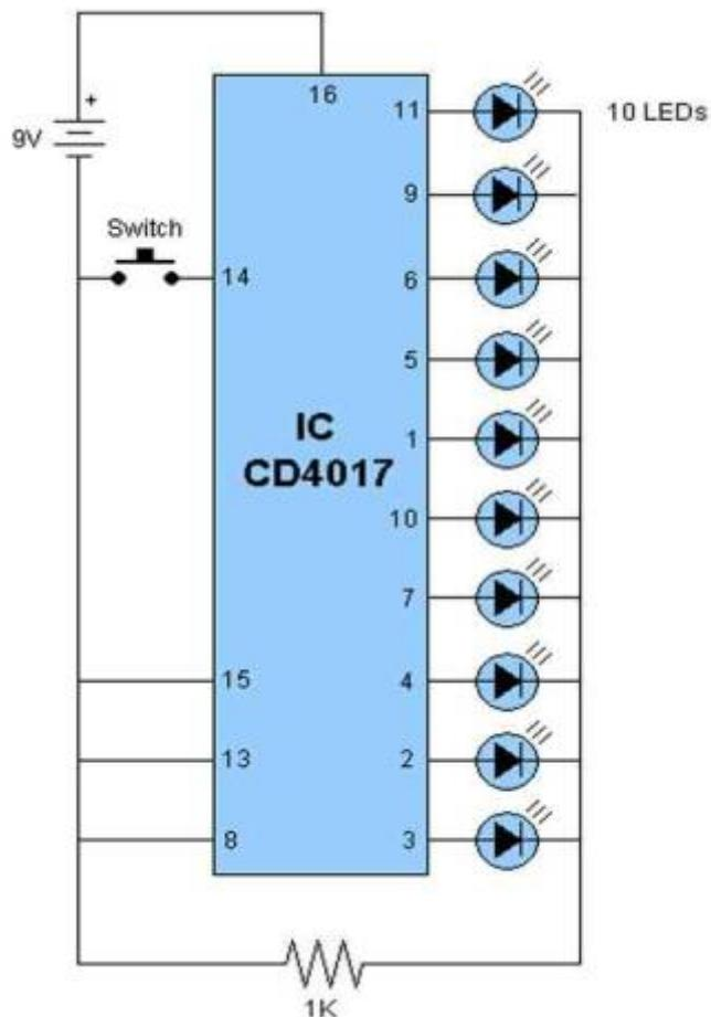
**Avec un arduino en raccordant une broche de sortie ( exemple 8) sur l'entrée Horloge du cd4017**
