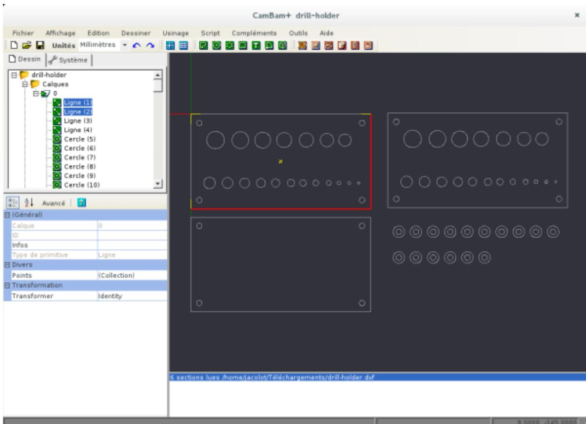
Pour éviter tout problème pour générer le G-code, il est nécessaire de joindre les segments du schéma (ou des parties du schémas), par joindre les segments:
