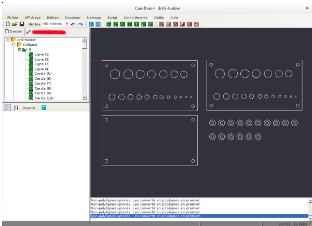
Vous pouvez aussi vérifier les dimensions de votre schéma en utilisant la souris tout en se déplaçant sur le modèle (en haut à droite, en bas à gauche, en bas à droite), vérifier les coordonnées X et Y en bas à droite (voir capture d'écran):
