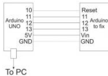
1. -Connectez l'Arduino UNO sur l'Arduino à réparer comme suit.
