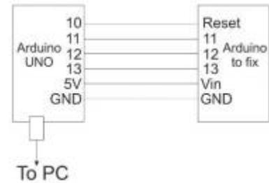
1. -Connectez l'Arduino UNO sur l'Arduino à réparer comme suit.
