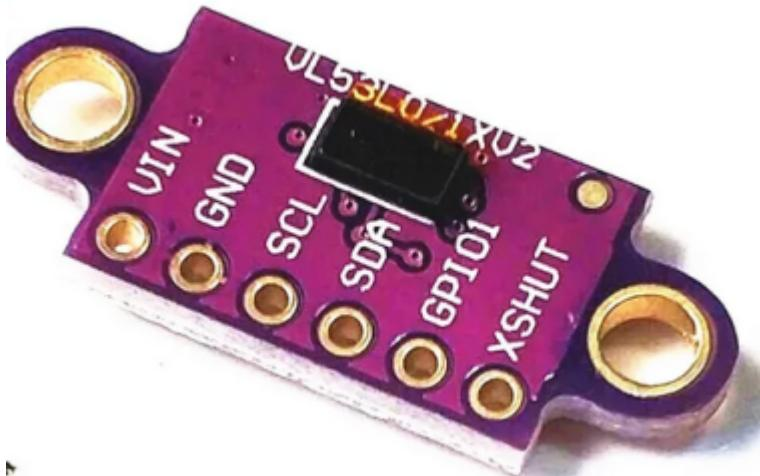
Le télémètre laser **VL53L1X** Arduino est un capteur permettant de mesurer la distance d'un obstacle **jusqu'à 4 mètres** de distance avec une longueur d'onde de 940 nm (inoffensif pour les yeux). Les modules télémétriques **VL53LOX**, moins chers, ont **une portée de seulement 2 mètres**.
