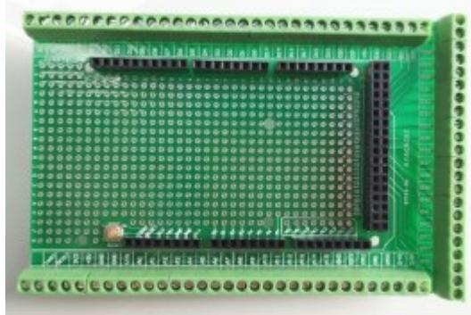
Sheild raccordement à vis arduino Méga
