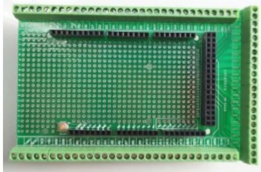
Sheild raccordement à vis arduino Méga
