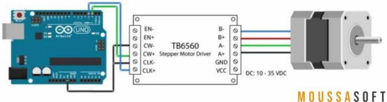
Comment utiliser TB6560 Contrôleur Moteur pas à pas avec Arduino
