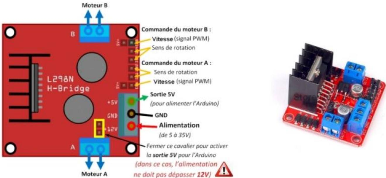
**Carte de contrôle des moteurs (L298N – «double pont en H») :**
