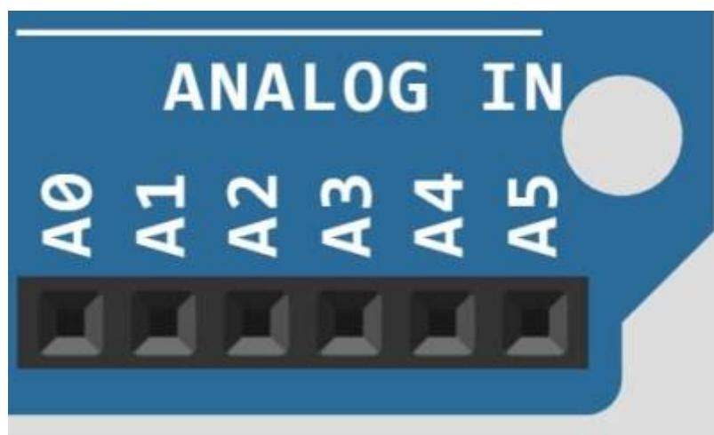
Arduino UNO dispose de six broches d'entrée analogiques étiquetées A0, A1, A2, A3, A4 et A5.
