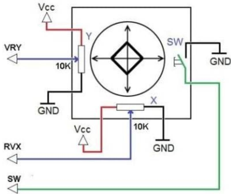
L'image ci-dessus montre une représentation électrique d'un joystick à deux axes. Vous pouvez également voir l'option de commutation.
