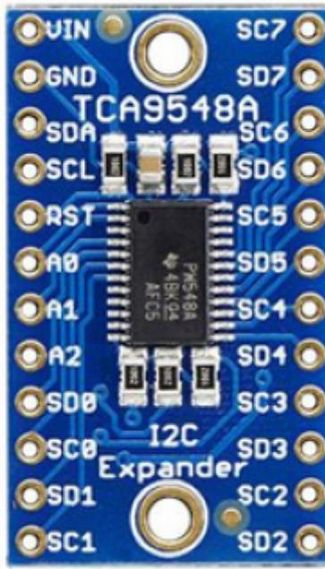
permettant de raccorder jusqu'à 8 modules I2C avec la même adresse sur le même bus I2C d'un microcontrôleur.
